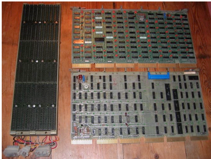
Figure 10.2 – Un fond de panier UNIBUS de PDP-11 avec plusieurs cartes insérées. Les connecteurs distribuent les lignes du bus commun par lesquelles communiquent le processeur, la mémoire et les contrôleurs de périphériques.
