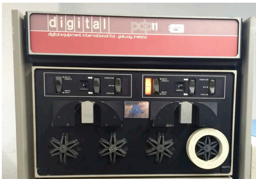
Figure 8.2 – Transport double TU56 pour rubans DECTape, ici associé à un PDP-11.
