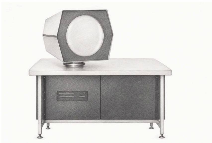
Figure 8.4 – Precision CRT Display Type 30 de DEC , présenté avec son meuble électronique. Son tube cathodique circulaire de 30 pouces était destiné à l’affichage graphique de grande précision.
