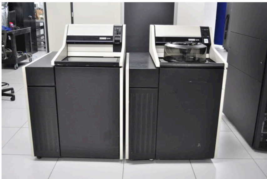
Figure 8.3 – Deux unités de disques RP06 de DEC . Apparu dans les années 1970, ce modèle appartient à la famille RP, destinée aux systèmes nécessitant une capacité de stockage importante.
