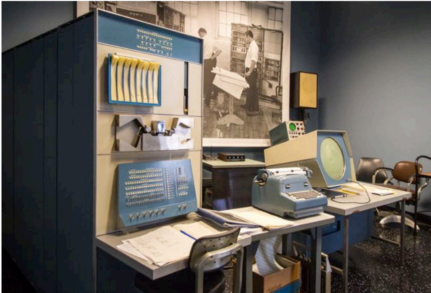
Figure 5.1 – PDP-1 présenté dans le laboratoire de démonstration du Computer History Museum à Mountain View. On distingue l'unité centrale, le pupitre de commande, le télétype et l'écran à tube cathodique.
